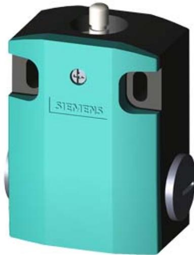
SIRIUS POSITIONSSCHALTER, BASISCHALTER, METALL, 56MM, ERHOEHTER KORROSIONSSCHUTZ, GERAETEANSCHLUSS 3X (M20X1,5) 1S/ 2OE SPRUNGKONTAKTE FUNKTIONSFAEHIG BEI -40 GRAD, SCHOCK-UND SCHWINGPRUEFUNG NACH EN61373, KATEGORIE 1B
