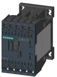
CONTACTOR, AC-3, 3KW/400V, 1NC, DC 220V 3-POLE, SZ S00 SPRING-LOADED TERMINAL
