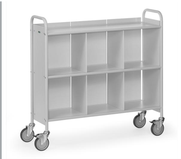
Baukasten-System: verschraubte Stahlrohr-Konstruktion, pulverbeschichtet in lichtgrau RAL 7035. Böden, Seiten- und Trennwände und Längswand aus Holzwerkstoffplatten, hellgrau. 4 Lenkrollen, Räder mit TPE-Bereifung, elastisch und leicht laufend, spurlos. Naben mit Gleitlager. 2 Lenkrollen mit Feststeller, gemäß der Europäischen Norm EN 1757-3 (Sicherheit von Plattformwagen). Zerlegte Anlieferung, leichte Selbstmontage. Gesamtlänge: 1165 mm, Gesamtbreite: 385 mm, Tragkraft pro Etage 50 kg.
