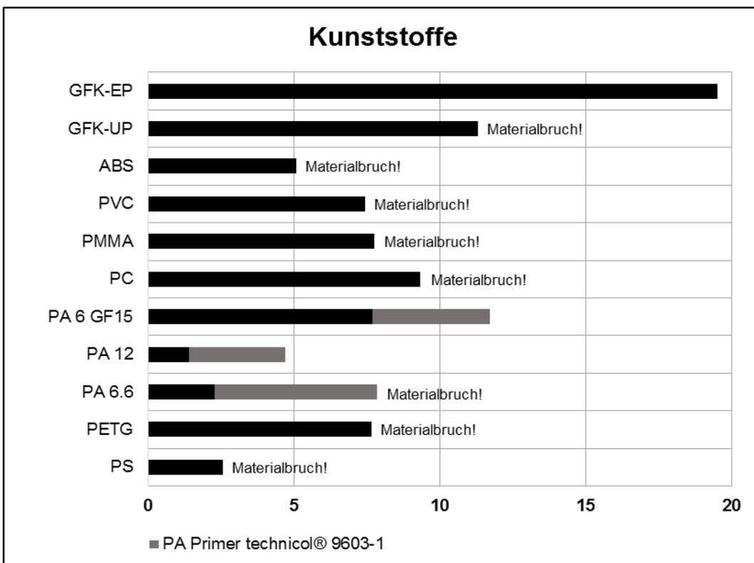
Vorbehandlung: Prüfkörper gereinigt, Metalle sandgestrahlt. Kunststoffe und verzinkte Metalle leicht angeraut.
