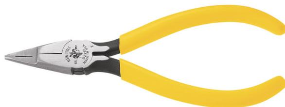
Einwandfreie Entmantelung von Kabeln mit 0,25 bis 0,34 mm<sup>2</sup> (22 bis 24 AWG). Praktischer Schlitz zum Aufbrechen der Isolierung. Gekrümmte Griffe bieten bessere Kontrolle über das Werkzeug. Komfortable, tauchisolierte Griffe.
