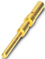
Crimpkontakt, Stift, gedreht, Kontaktdurchmesser: 0,8 mm, Crimpbereich: 0,08 mm<sup>2</sup> ... 0,34 mm<sup>2</sup>, Artikel ist bleifrei nach RoHS II ohne Ausnahme 6c (Pb < 0,1 %)
