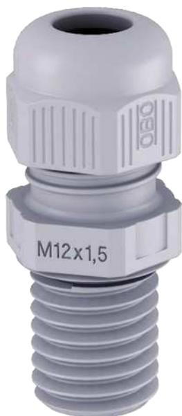
Kabelverschraubung mit metrischem Anschlussgewinde in Hutmutterbauart, für Kabelabzweiggkisten, Gehäuse, Verteilerschränke im privaten und industriellen Bereich. Mit Zugentlastung und integrierter Dichtlippe, geprüft nach DIN EN 62444. Schutzklasse IP68. Einsetzbar von -20°C bis +65°C.
