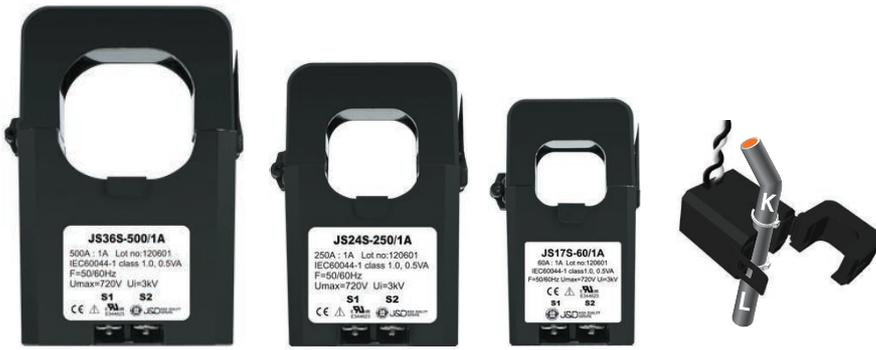
Diese Klappkernwandler liefern ausgehend von den erfassten Eingangsnennströmen jeweils einen sekundären Ausgangsstrom von 1A. Sie sind für Stromzähler und Leistungsmesser in Stromverteilungen, Bedienpulten, Schaltgeräten und anderen Einrichtungen einsetzbar. Durch Ihren Klappmechanismus können Sie auf Stromleitungen aufgesetzt werden, ohne dass diese unterbrochen werden müssen. Der eingebaute ausgangsseitige Überspannungsschutz ermöglicht eine sichere Montage.
