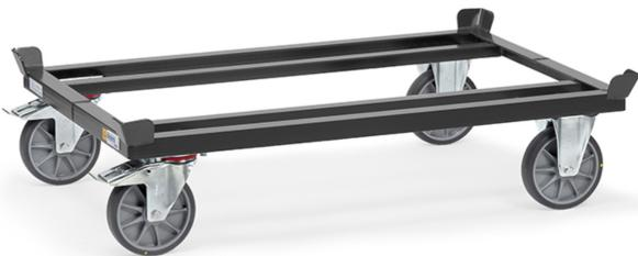
Für Flachpaletten und Gitterboxen. Robuste Winkelstahl-Schweißkonstruktion, mit 4 Fangecken, pulverbeschichtet, schiefergrau RAL 7015. 2 Lenk- und 2 Bockrollen, TPE-ESD-Bereifung, Naben mit Rillenkugellager, Feststeller an den Lenkrollen, gemäß der europäischen Norm EN 1757-3 (Sicherheit von Plattformwagen). Sehr geringer Anfahr-, Roll- und Schwenkwiderstand. Geräuscharmer Lauf auf ebenen Böden. Reifen nicht kreidend (spurlos).
