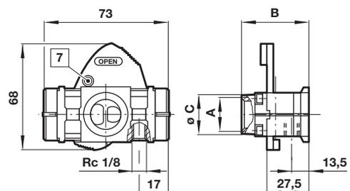
7 Bohrung für Vorhängeschloss ø7,5 mm
