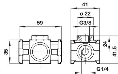
Anschlussflansch mit Druckschalter
