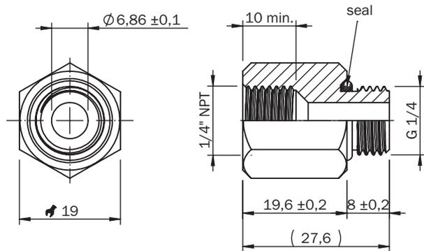
Unterseite: ¼" NPT-Innengewinde, vormontierter NPT-Adapter in G ¼-Innengewinde, Rückseite: G ¼-Innengewinde
