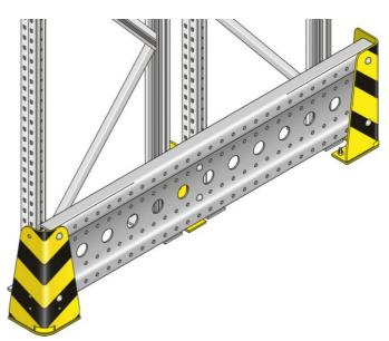
Palettenregal PR 600 Besonders gefährdete Bereiche von Palettenregalen, z. B. Durchfahrten oder stark frequentierte Fahrgänge, sollten durch einen stabilen Rammschutz gesichert werden Mit stabilem C-Sigma-Profil, 400 mm hoch, 75 mm breit 2 x Eckschutz inkl. Bodenanker Ab 1800 mm Länge mit Zusatzstütze mittig Für Rahmentiefe: wahlweise 850, 1050, 1100, 1800 oder 2450 mm
