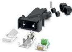
D-SUB-Steckverbinder, Schutzart: IP67, Polzahl: 9, Material: Kunststoff, Anschlussart: Schraubanschluss, Anschlussquerschnitt: AWG 26- 16, Kabelabgang: schräg, mit integriertem Abschlusswiderstand, Gehäusegröße: 1, Farbe: schwarz, PROFIBUS
