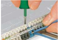
Leiter anschließen/lösen – Serie 256.
