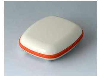
B1604107 BODY-CASE M, ohne Vertiefung ASA (UL 94 HB) verkehrsweiß RAL 9016 50x41x15mm IP 65
