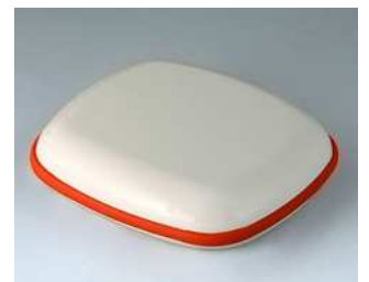
B1608107 BODY-CASE XL, ohne Vertiefung ASA (UL 94 HB) verkehrsweiß RAL 9016 62x56x18mm IP 65
