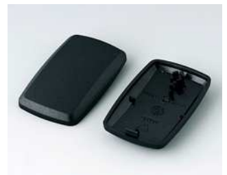
B9002856 Unter- und Oberteil ES PMMA (IR) (UL 94 HB) schwarz RAL 9005 52x32x15mm
