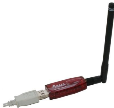
USB Stick mit AMB1981 Antenne*
