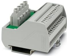
VARIOFACE-Modul, mit zwei Potenzi­alschienen (P1, P2) zur Potenzialverteilung, zur Montage auf NS 35-Tragschienen. Modulbreite: 70,4 mm
