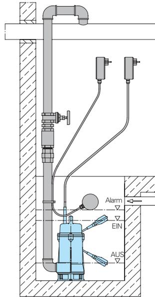
**Schachtinstallation mit automatischem Kupplungssystem.**
