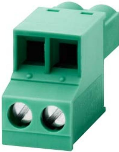
STECKER, WEIBLICH, 2-POLIG, DC 24 V FUER SIMATIC HMI PANEL, AUSSER KEY PANEL, DRAHTQUERSCHNITT BIS 0,75 MM2 MENGE: SIEHE TECHNISCHE DATEN
