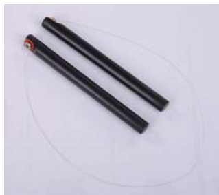
Schneidedraht mit Griffen zum Ablösen des Displays.
