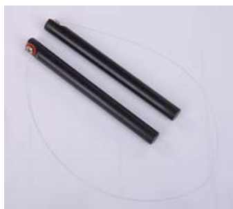
Linka wraz z uchwytami do separacji ekranu wyświetlacza.
