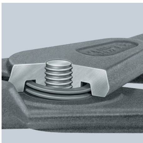
Molla interna: posizione protetta dentro la precisa articolazione a vite. Non ostacola il lavoro, non si sporca e non si perde
