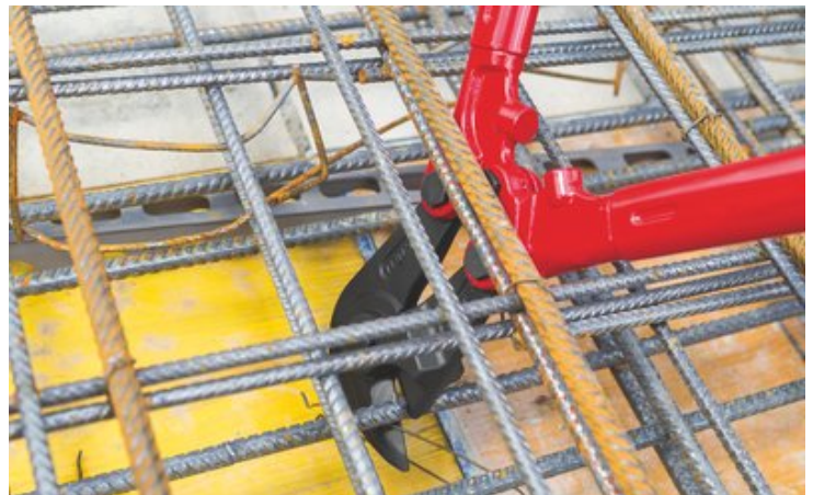
A 71 82 950 hálózó különleges fejműve fekvő szerkezeti acélok vágását teszi lehetővé
