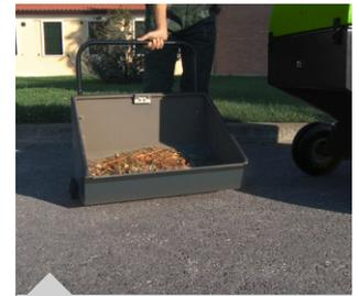
Manuelle Entleerung des Kehrgutbehälters
