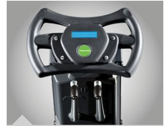
Elektronische Steuerungskonsole mit Diagnostik und 2 Hebeln für die Seitenbürsten
