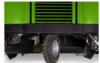
Der Antrieb über das hintere Antriebsrad ermöglicht wendiges und sicheres Fahren mit sehr engen Kurvenradien
