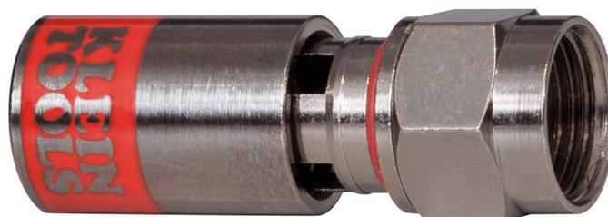
Die patentierte Technologie mit Universalhülsen von Klein ermöglicht eine bis zu 2-mal schnellere Montage als mit anderen Kompressionssteckverbindern. Patentierte Sichtfenster in der Hülse helfen bei der korrekten Positionierung. Ein Verbinder passt auf alle Durchmesservarianten einer Kabelserie. Dieses patentierte Hülsendesign bietet die hervorragende Haltekraft und Signalstärke, die Profis benötigen.
