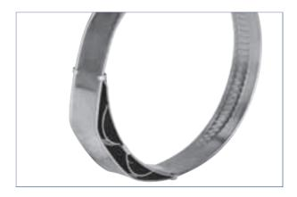
Bei dieser Version der NORMACLAMP® TORRO® wird auf der Bandinnenseite eine Wellfeder angebracht. Beim Anziehen wird diese vorgespannt, so dass die dadurch gespeicherte Federenergie für einen anhaltenden selbsttätigen Nachspanneffekt sorgt. Selbst bei extremen Temperaturen kann so noch eine ausreichende radiale Spannkraft erreicht werden.
