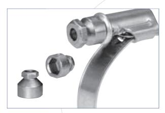
Die Drehmomentkappe schert beim Erreichen des zulässigen Andrehmoments ab und erspart somit einen Drehmomentschlüssel. Der Schraubenschlitz ist nach dem Sollbruch wieder zugänglich, so dass die Schelle demontiert und/oder gegebenenfalls nachgespannt werden kann.
