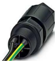
Wanddurchführung, QUICKON-Anschluss, Polzahl: 2+PE, 0,5 mm<sup>2</sup> ... 1,5 mm<sup>2</sup>, 690 V, 17,5 A, schwarz, mit QUICKON-Mutter, Leitungsaußendurchmesser: 10 mm ... 13 mm, Montagegewinde: M20, Einzeladern, 1,5 mm<sup>2</sup>, Leitungslänge: 1 m
