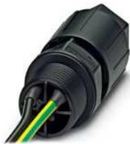
Wanddurchführung, QUICKON-Anschluss, Polzahl: 2+PE, 0,5 mm<sup>2</sup> ... 1,5 mm<sup>2</sup>, 690 V, 17,5 A, schwarz, mit QUICKON-Mutter, Leitungsaußendurchmesser: 10 mm ... 13 mm, Montagegewinde: M20, Einzeladern, 1,5 mm<sup>2</sup>, Leitungslänge: 0,5 m
