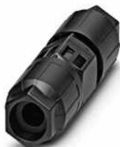
Leitungsverbinder, QUICKON-Anschluss, Polzahl: 2+PE, 0,5 mm<sup>2</sup> ... 1,5 mm<sup>2</sup>, 690 V, 17,5 A, schwarz, mit zwei QUICKON-Muttern, Leitungsaußendurchmesser: 10 mm ... 13 mm, QUICKON-Schnellanschluss
