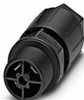
Wanddurchführung, QUICKON-Anschluss, Polzahl: 2+PE, 0,5 mm<sup>2</sup> ... 1,5 mm<sup>2</sup>, 690 V, 15 A, schwarz, mit QUICKON-Mutter, Leitungsaußendurchmesser: 10 mm ... 13 mm, Montagegewinde: M20, Flachsteckanschluss (für Flachsteckhülsen nach DIN 46247-2), 1,5 mm<sup>2</sup>
