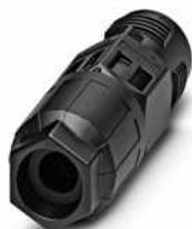
Leitungsverbinder, QUICKON-Anschluss, Polzahl: 2+PE, 0,5 mm<sup>2</sup> ... 1,5 mm<sup>2</sup>, 690 V, 17,5 A, schwarz, mit einer QUICKON-Mutter, Leitungsaußendurchmesser : 10 mm ... 13 mm, QUICKON-Schnellanschluss
