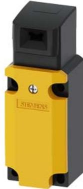
Sicherheits-Positionsschalter mit getrenntem Betätiger Metallgehäuse, 40 mm Geräteanschluss 1x (M20 x 1,5) Schleichschaltglieder 1S/2Ö 5 Anfahrrichtungen der dazu passende getrennte Betätiger 3SE5000-0AV0. muss separat bestellt werden
