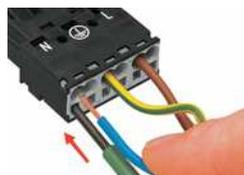
Zum Anschluss feindrätiger Leiter Klemmfeder mittels Schraubendreher (Klingenbreite 2,5 mm) betätigen und abisolierten Leiter bis zum Anschlag einführen.
