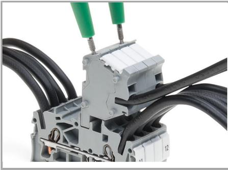
Die TOPJOB®S-Steckverbinder verfügen über eine Prüfbuchse (Durchmesser 2 mm), an der Spannungsprüfungen mit 2-poligem Spannungsprüfer vorgenommen werden können.
