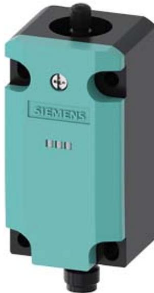
Basisschalter für Positionsschalter 3SE51 Metallgehäuse 40 mm nach DIN EN 50041 1S/1Ö Sprungschaltglied mit M12-Stecker, 5-polig, fest mit 2 LED, gelb/grün, DC 24 V 4 A, ohne Antriebskopf Pin-Belegung: Pin1=21+13 Brücke + LED grün Pin2=22, Pin3=Masse LED Pin4=14 + LED gelb, Pin5=PE
