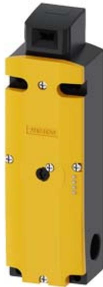
Sicherheits-Positionsschalter mit Zuhaltung Zuhaltkraft 1300 N 5 Anfahrichtungen Kunststoffgehäuse, 3x(M20x1,5) Federkraftverriegelt Hilfsentriegelung vorne Magnetspannung DC 24 V Überwachung Betätiger 2Ö/1S Überwachung Magnet 2Ö/1S LED-Anzeige gelb/grün Lieferung ohne Betätiger Betätiger 3SE5000-0AV0. bitte separat bestellen Kabelverschraubung IP69 verwenden
