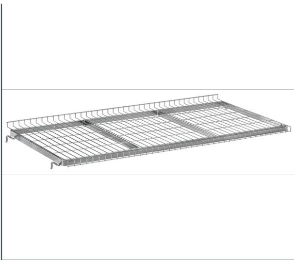
Etagenboden aus Drahtgitter 120 x 30 mm, galvanisch glanzverzinkt. An einer Längsseite 23 mm nach oben, an der anderen 23 mm unten abgekantet. Im Raster von 100 mm waagrecht oder geneigt einhängbar. Tragkraft pro Boden 80 kg
