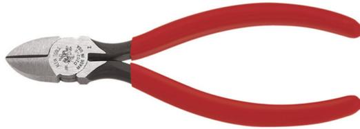
Einfache Verwendung in beengten Bereichen. Federbelastet zur Selbstöffnung. Kurze Backen und abgeschrägte Schneidkanten erlauben kurze Schnitte. Induktionsgehärtete Messerklingen sorgen für Langlebigkeit. Warm genietetes Scharnier sorgt für reibungslose Arbeit ohne Wackeln der Griffe. Kunststoff-getauchte Griffe zur bequemen Handhabung und leichten Erkennung. Werkzeug-Spezialstahl, Made in USA.
