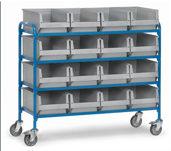
Baukasten-System: Stahlrohr- und Profilstahl geschweißt, pulverbeschichtet blau RAL 5007, Schraubkonstruktion. 4 Etagen mit Holzwerkstoffplatten, Rand 10 mm hoch und 16 Sichtlagerkästen (LxBxH: 500/450 x 310 x 200 mm). Tragkraft pro Ladefläche 60 kg. 4 Lenkrollen, TPE-Bereifung, Naben mit Rillenkugellager. 2 Stück mit Feststeller, gemäß der Europäischen Norm EN 1757-3 (Sicherheit von Plattformwagen). Zerlegte Anlieferung.
