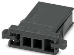
Leiterplattenstecker, Farbe: schwarz, Nennstrom: 8 A, Bemessungsspannung (III/2): 160 V, Kontaktart: Buchse, Anzahl der Reihen: 1, Polzahl: 2, Artikelfamilie: D31PC 2,2/..., Rastermaß: 3,81 mm, Anschlussart: Crimpanschluss, Anschlussrichtung Leiter/Platine: 0 °, Rasthaken: - ohne Rasthaken, Stecksystem: CONNEXIS D, Verriegelung: Rastverriegelung, Befestigungsart: Rastflansch, Verpackungsart: verpackt im Karton
