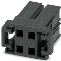
Leiterplattenstecker, Farbe: schwarz, Nennstrom: 8 A, Bemessungsspannung (III/2): 320 V, Kontaktart: Buchse, Anzahl der Reihen: 2, Polzahl: 4, Artikelfamilie: DD32PC 2,2/..., Rastermaß: 5,08 mm, Anschlussart: Crimpanschluss, Anschlussrichtung Leiter/Platine: 0 °, Rasthaken: - ohne Rasthaken, Stecksystem: CONNEXIS DD, Verriegelung: Rastverriegelung, Befestigungsart: Rastflansch, Verpackungsart: verpackt im Karton
