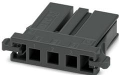
Leiterplattenstecker, Farbe: schwarz, Nennstrom: 8 A, Bemessungsspannung (III/2): 320 V, Kontaktart: Buchse, Anzahl der Reihen: 1, Polzahl: 3, Artikelfamilie: D32PC 2,2/..., Rastermaß: 5,08 mm, Anschlussart: Crimpanschluss, Anschlussrichtung Leiter/Platine: 0 °, Rasthaken: - ohne Rasthaken, Stecksystem: CONNEXIS D, Verriegelung: Rastverriegelung, Befestigungsart: Rastflansch, Verpackungsart: verpackt im Karton
