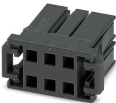
Leiterplattenstecker, Farbe: schwarz, Nennstrom: 8 A, Bemessungsspannung (III/2): 320 V, Kontaktart: Buchse, Anzahl der Reihen: 2, Polzahl: 6, Artikelfamilie: DD32PC 2,2/..., Rastermaß: 5,08 mm, Anschlussart: Crimpanschluss, Anschlussrichtung Leiter/Platine: 0 °, Rasthaken: - ohne Rasthaken, Stecksystem: CONNEXIS DD, Verriegelung: Rastverriegelung, Befestigungsart: Rastflansch, Verpackungsart: verpackt im Karton
