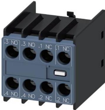
Hilfsschalter, elektronikgerecht, frontseitig, 2 S + 2 Ö, .3/4, .3/4, .1/2, .1/2, Strombahn: 1 S (elektronikgerecht), 1S, 1 Ö, 1 Ö (elektronikgerecht), Schraubanschluss, für Schütze 3RT2 und Hilfsschütze 3RH2
