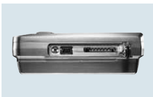
Seitlicher Anschluss von Mini-USB-Kabel und SD-Karte
