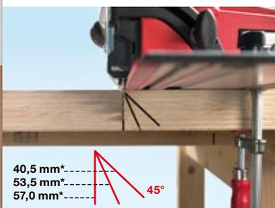
Bei einer Blattstellung von  $0^\circ$  sind Schnitttiefen bis  $57\text{ mm}^*$  möglich. Durch das Schwenksystem sind selbst bei Schrägschnitten kaum Grenzen gesetzt. Bei  $45^\circ$  Grad beträgt die Schnitttiefe immer noch  $40,5\text{ mm}^*$ .
