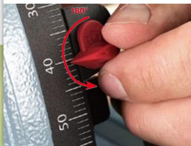
Die Schnitttiefe kann millimetergenau justiert werden. Mit oder ohne Schiene – durch eine einfache Drehung zeigt der Schnitttiefenanzeiger immer die exakte Position des Sägeblatts an.
