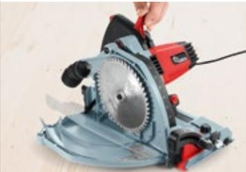
Für den schnellsten Sägeblattwechsel der Welt: Einfach Entriegelungsknopf drücken und Hebel anheben. Das Gehäuse öffnet sich und das Sägeblatt kann im Handumdrehen gewechselt werden. Bei geöffneter Sägeblattabdeckung sind automatisch die Einschaltsperrung sowie die Sägeblattarretierung aktiviert.
