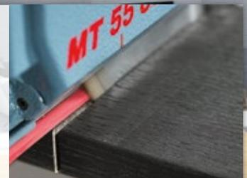
**Die MT 55 ist ein hochpräzises Multitalent: Sie meistert Tauch-, Trenn-, Schräg- und Winkelschnitte ohne Ausrisse. Sie sägt Span-, Multiplex-, Mehrschicht-, Dreischicht-, OSB-, Gipsfaser-, Weichfaser-, Faserzement- und Schichtstoffplatten ebenso präzise wie Massivholz, Plexiglas, Aluminium, Aluprofile sowie Laminat- und Bodenplatten.**
