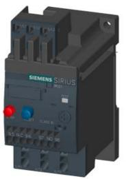
OVERLOAD RELAY 7.0...10 A FOR MOTOR PROTECTION SZ S00, CLASS 10, STAND-ALONE INSTALLATION MAIN CIRCUIT: SPRING TERMINAL AUX. CIRCUIT: SPRING TERMINAL MANUAL-AUTOMATIC-RESET
