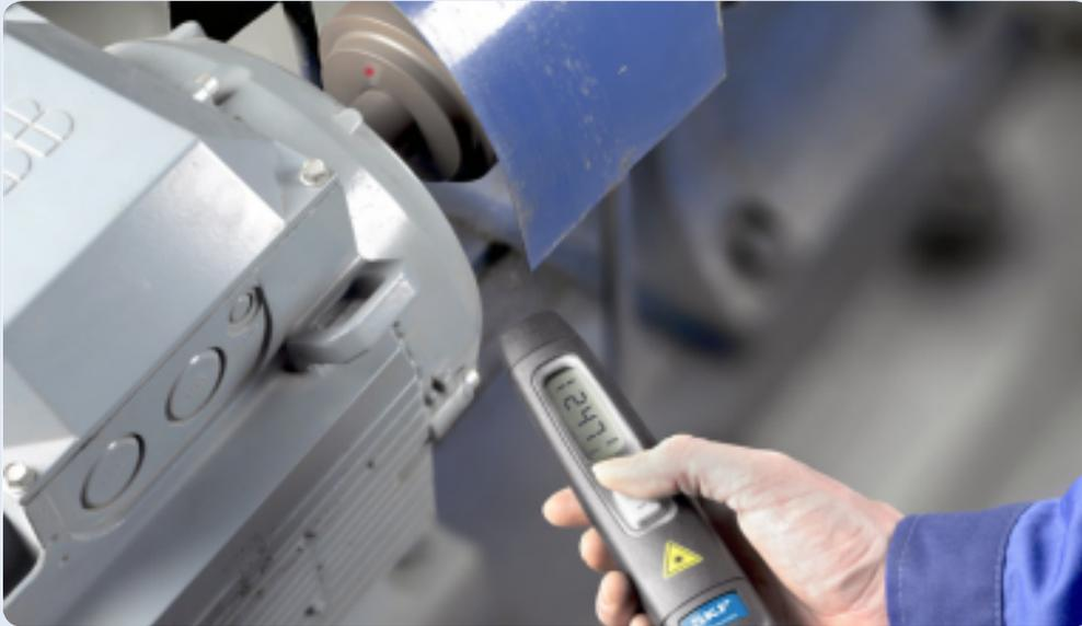
Lasersystem für einfache und sichere Fernmessungen an rotierenden Maschinen
