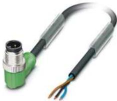
Sensor-/Aktor-Kabel, 3-polig, PVC, schwarz RAL 9005, Stecker gewinkelt M12, Kodierung: A, auf freies Leitungsende, Kabellänge: 1,5 m
