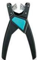
Abisolierzange, für halogenfreie Sensor-/Aktor-Leitungen (SAC-Leitungen), mit PUR und PVC Isolierung, von Ø 4,4 bis 7 mm, Abisolierlänge beliebig
