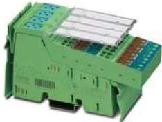
Inline, Digitaleingabeklemme, Digitale Eingänge: 16, 24 V DC, Anschlusstechnik: 3-Leiter, Übertragungsgeschwindigkeit im Lokalbus: 500 kBit/s, Schutzart: IP20, inklusive Inline-Steckern und Beschriftungsfeldern
