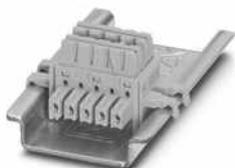
Tragschienen-Busverbinder (TBUS), 5-polig, zur Brückung der Versorgungsspannung, aufschnappbar auf Tragschiene NS 35/... nach EN 60715
