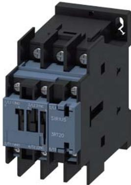
Leistungsschütz, AC-3e/AC-3, 17 A, 7,5 kW / 400 V, 3-polig, AC 110 V, 50 Hz / 120 V, 60 Hz, Hilfskontakte: 1 S + 1 Ö, Ringkabelschuhanschluss, Baugröße: S0
