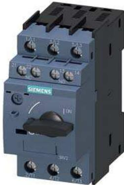
Sondertyp Leistungsschalter Baugröße S00 für den Motorschutz, CLASS 10 A-Auslöser 3,5...5 A N-Auslöser 65 A Schraubanschluss Standardschaltvermögen mit querliegenden Hilfsschalter 1S+1Ö Umgebungstemperatur -50 °C 500 Schaltspiele
