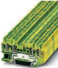
Morsetti comp. per conduttori terra, Collegamento: Connessione a molla, Sezione: 0,08 mm<sup>2</sup> - 4 mm<sup>2</sup>, AWG: 28 - 12, Larghezza: 5,2 mm, Colore: giallo-verde, Tipo di montaggio: NS 35/7,5, NS 35/15
