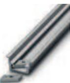
Guida di supporto, profilata, esecuzione alta, non perforata, spessore 1,5 mm, materiale: alluminio, altezza 15 mm, larghezza 35 mm, lunghezza 2000 mm
