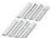
Nastro Zack piatto, Striscia, bianco, siglato, siglatura longitudinale: numeri progressivi 1-10, 11-20 ecc. fino a 491-500, Tipo di montaggio: Inserimento a scatto in scanalatura piatta portacartellini, per morsetti con spessore: 5 mm, Dimensioni campo di siglatura: 5,15 x 5,15 mm
