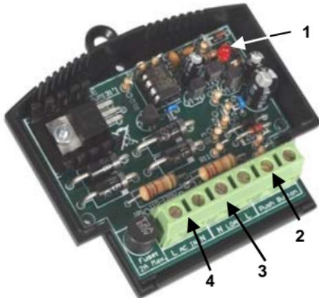
Dieses Dimmermodul ist zur Regelung der Lichtstärke von Glühlampen, Halogenbeleuchtung auf Netzspannung und Niedervolt-Halogenbeleuchtung mit einem elektronischen Transformator konzipiert worden. Die verwendete Technik ist Phasenabschnitt. Die Vorteile dieser Technik sind einerseits, dass dieser Dimmer wenig Störungen im Lichtnetz generiert und andererseits, dass dieser Dimmer geeignet ist für die Steuerung elektronischer Transformatoren bei Niedervolt-Halogenbeleuchtung.
