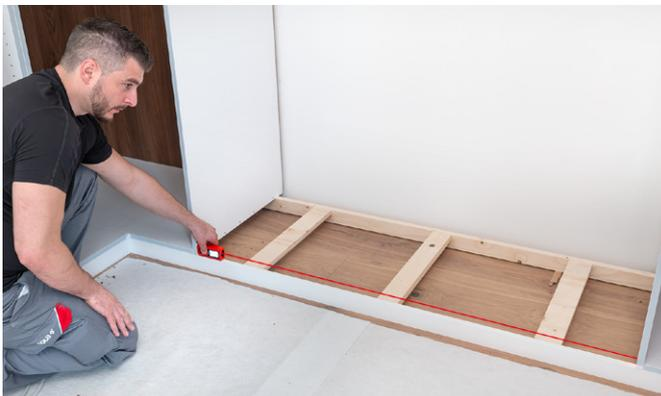
Besonders hilfreich für den Anwender ist die integrierte Libelle im VECTOR 50. Diese Libelle sorgt dafür, dass das Gerät bei waagrecht Messungen korrekt ausgerichtet wird. Der Vorteil: präzisere Messergebnisse.
