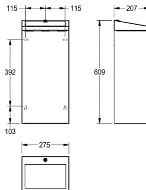
Abfallbehälter für Aufputzmontage, Chromnickelstahl, Oberfläche seidenmatt, Materialstärke 0,8 mm, abgeschrägter, selbstschliessender Klappeckel, herausklappbare Sackhalterung, Zylinderschloss mit Franke Einheitsschlüssel, Fassungsvermögen ca. 30 Liter, inklusive Edelstahlschrauben und Dübel.
