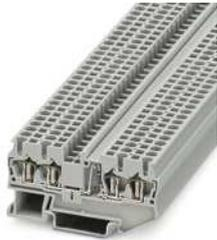
Bauelementreihenklemme, mit integrierter Diode, Nennspannung: 800 V, Nennstrom: 0,5 A, Anschlussart: Zugfederanschluss, Bemessungsquerschnitt: 1 mm<sup>2</sup>, Querschnitt: 0,08 mm<sup>2</sup> - 4 mm<sup>2</sup>, Montage: NS 35/7,5, NS 35/15, Farbe: grau
